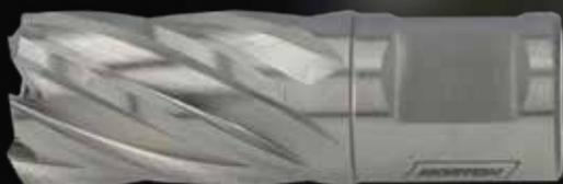
As brocas de núcleo Norton são melhor usadas com brocas magnéticas ou máquinas de prensa de broca. Uma broca de núcleo funciona de maneira diferente das brocas helicoidais convencionais, pois corta apenas uma ranhura na periferia do furo, deixando um núcleo sólido no centro que é ejetado pelo pino central. Isso resulta em uma perfuração mais rápida e fácil de furos maiores e uma vida útil da ferramenta muito mais longa.
